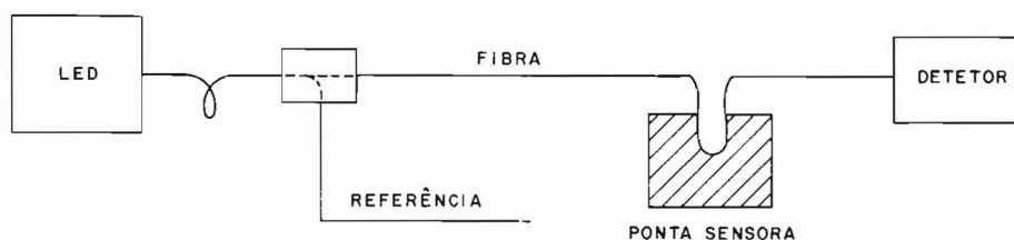
Figura 7. Montagem do sensor de temperatura baseado na variação do índice de refração de um líquido (a ponta sensora é uma fibra descascada e encapsulada junto com o líquido).
